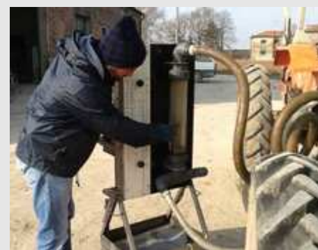
Fig. 11 – Esempi di determinazione della pressione di esercizio con l'ausilio del flussometro
