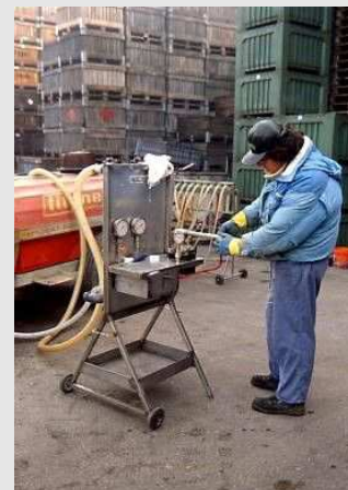
Fig. 2 - Banco per la verifica del manometro
