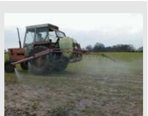
Fig. 8 – Barre fuori assetto non garantiscono una corretta sovrapposizione dei getti
