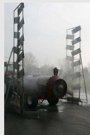
Fig. 12 – Definizione del diagramma di distribuzione su irroratrici per colture fruttivitticole
