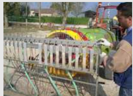
Fig. 3 - Verifica della portata e dello stato di usura degli ugelli su atomizzatore ad aeroconvezione
