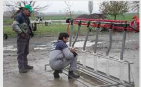
Fig. 4 – Esempi di verifica della portata e dello stato di usura degli ugelli su barre irroratrici a polverizzazione meccanica
