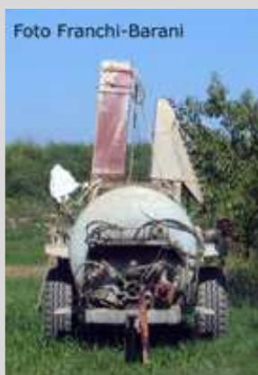
Foto 41 – Esempio di irroratrice utilizzata in pioppicoltura con testata erogatrice mista.
