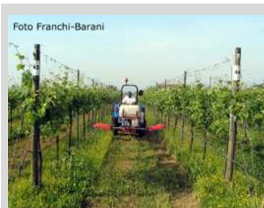
Foto 54 – Irroratrice per il diserbo localizzato sulla fila delle colture arboree.
