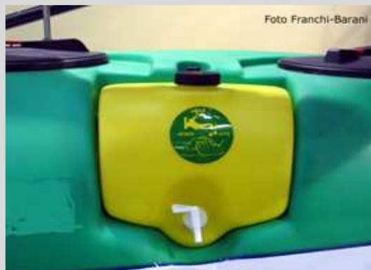
Foto 13 - Serbatoio ausiliario per l'igiene dell'operatore (lavamani).
