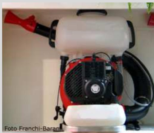
Foto 49 – Attrezzatura spalleggiata azionata da motore a scoppio.
