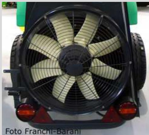
Foto 28 - Disposizione classica del ventilatore assiale montato su un atomizzatore ad aereoconvezione.
