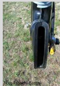
Foto 29 - Ugelli disposti all'interno (a sinistra) e all'esterno (a destra) del flusso d'aria.
