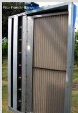
Foto 44 - Sistema di captazione e separazione lamellare dello spray.
