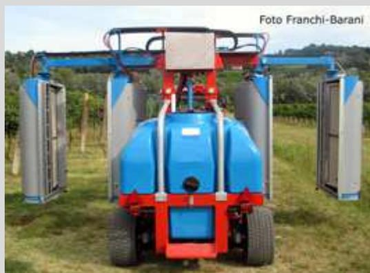
Foto 43 - Irroratrice a recupero di prodotto di tipo "a tunnel".
