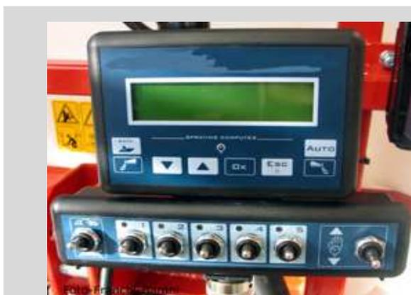
Foto 17 - Esempio di centralina per il comando elettrico a distanza.
