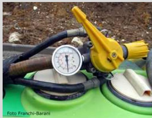
Foto 22 – Sistema di regolazione della portata a pressione costante (DPC).
