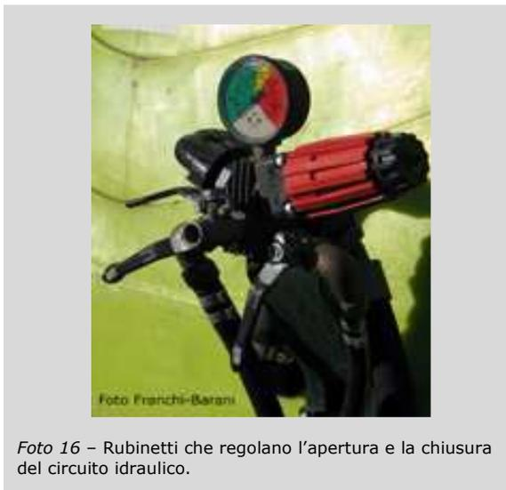
Foto 16 - Rubinetti che regolano l'apertura e la chiusura del circuito idraulico.
