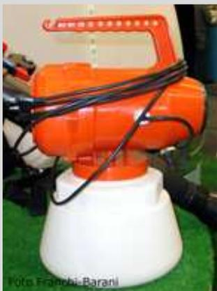
Foto 52 – Generatore di aerosol portatile.
