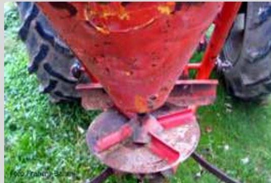
Foto 5 – Piattaforma rotante montata su un mezzo spandi granuli centrifugo.
