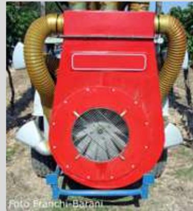
Foto 36 - Esempio di ventilatore radiale.
