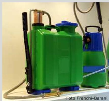
Foto 47 - Pompa a spalla.
