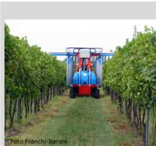
Foto 45 - Le irroratrici a "tunnel" sono impiegabili solo in forme di allevamento in parete.
