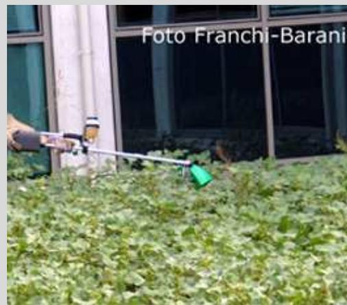
Foto 51 – Esempio di applicazione di erbicidi grazie al sistema di spruzzo ULV.
