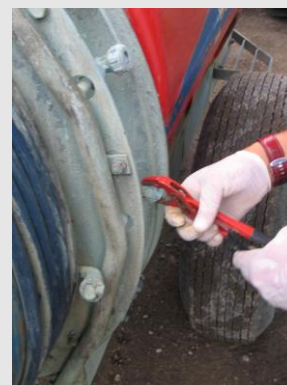
Manutenzione degli ugelli durante il controllo funzionale (Foto Cons. Fito. Reggio Emilia)
