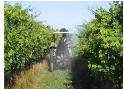
Irrorazione dei due filari esterni solamente verso l'interno dell'impianto per evitare deriva in prossimità di abitazioni, strade, altre colture, ecc. (Foto Cons. Fito. Reggio Emilia)
